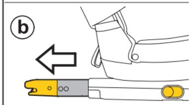
**2.** Attachez les connecteurs aux fixations du siège de votre véhicule, en vous assurant qu'ils se « clipsent » lorsqu'ils sont bien positionnés.
