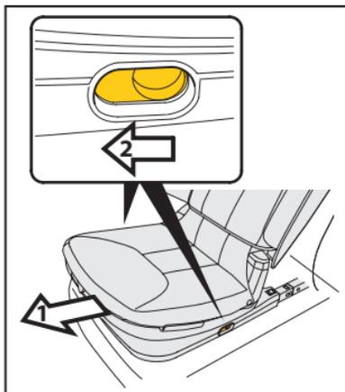
**6.** Pour repositionner les connecteurs à l'intérieur de la base (lorsqu'ils ne servent pas), tirez le levier encore une fois (1) et, en même temps, enfoncez l'un des deux connecteurs (2) jusqu'à ce qu'ils disparaissent.
