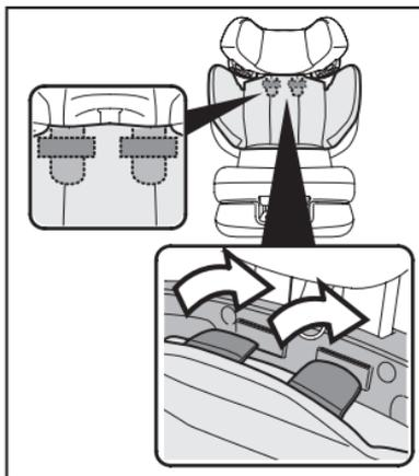
**6.** Glisser la housse de côté et fixer les deux élastiques supérieurs; répéter l'opération avec les élastiques inférieurs.
