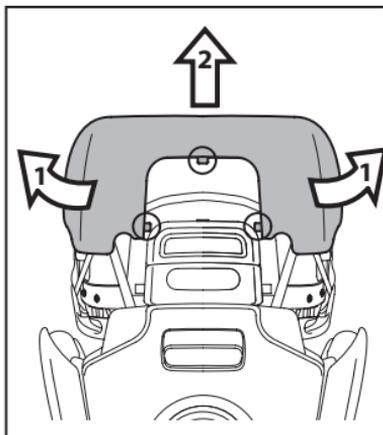
**10.** Pour retirer la housse de l'appuie-tête, soulevez légèrement celui-ci et défaites les deux élastiques situés d'un côté (fig\_a) puis les deux autres élastiques situés de l'autre côté (fig\_b). Retirez la housse.
