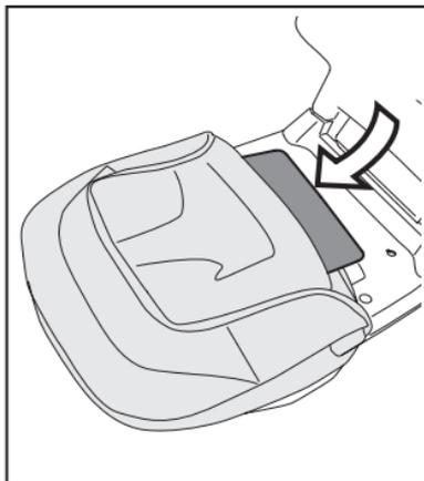
**2.** Glisser par l'avant du siège-auto la housse (fig\_a) en insérant le profil dans l'emplacement approprié (fig\_b).
