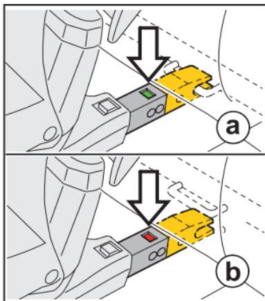
4. Après avoir attaché le siège, tirez à nouveau la poignée avant (fig\_a) et, en même temps, poussez le siège-auto en direction du siège de votre voiture (fig\_b), puis relâchez la poignée.
